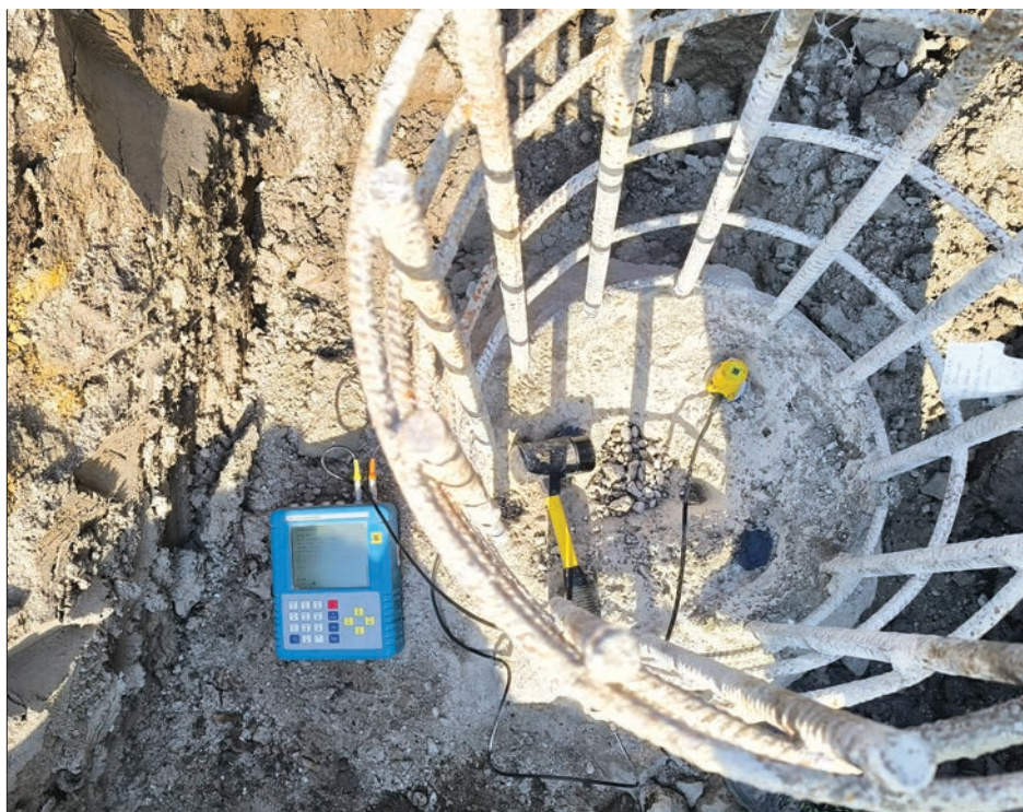
Obr. 1 Aparatúra pripravená na výkon skúšky pilóty metódou PIT
