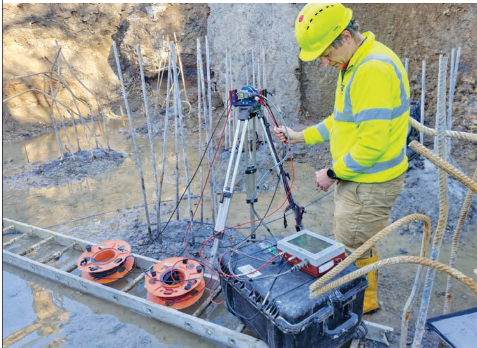
Obr. 3 Meracia aparatura zostavená na výkon skúšky CHA s obsluhou
