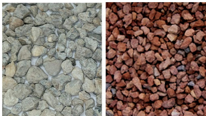
Obr. 1 Hrubé betónové recyklované kamenivo, tehlový recyklát Fig. 1 Coarse recycled concrete aggregate and recycled brick aggregate
