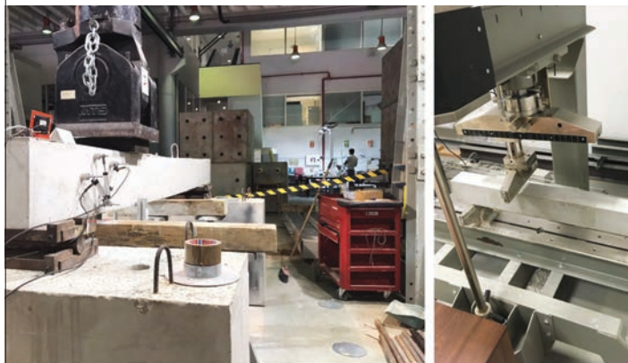
Obr. 3 Skúšaný nosník osadený v zostave pripravený na skúšanie Fig. 3 The tested beams mounted in the testing assembly
