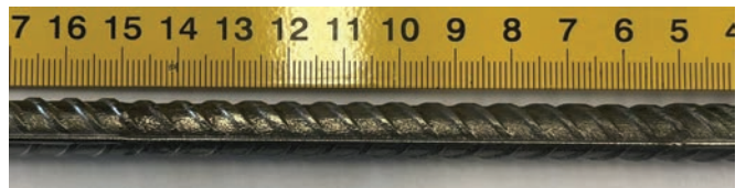
Obr. 6 Morfológia korózie na reprezentatívnej vzorke pri pH 2,5 Fig. 6 Corrosion morphology on a representative sample at pH 2.5
