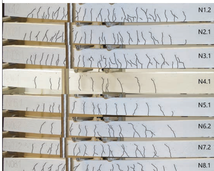
Obr. 4 Nosníky na úrovni 95 % zaťaženia: s GFRP výstužou s opieskovaným povrchom (N01.2, N02.2, N03.1), s ocelovou výstužou (N04.1, N05.1), s GFRP výstužou s ovintým povrchom (N06.2, N07.2, N08.2)
