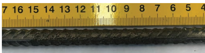
Obr. 5 Morfológia korózie na reprezentatívnej vzorke pri pH 7,0 Fig. 5 Corrosion morphology on a representative sample at pH 7.0
