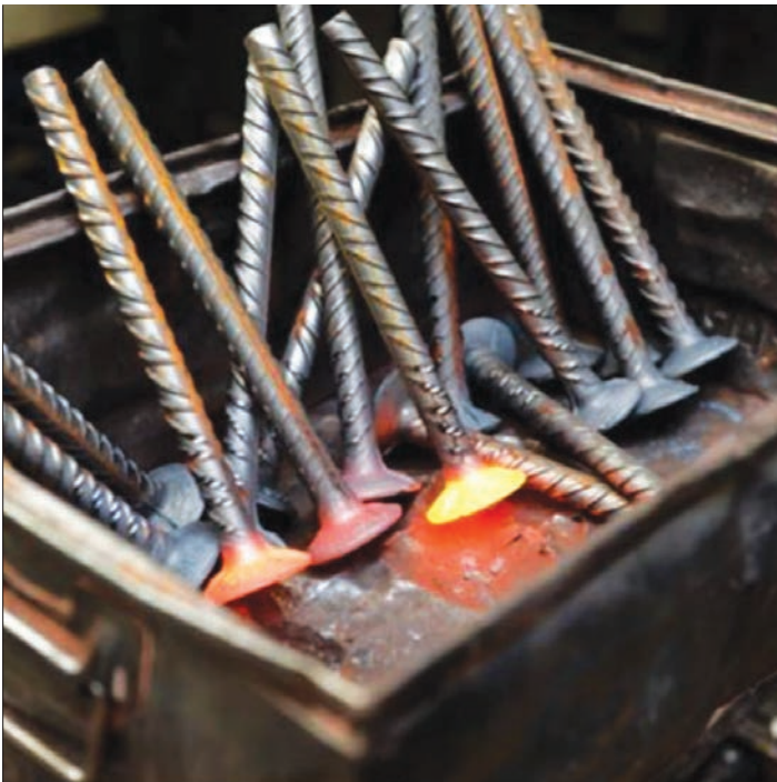
Obr. 3 Hlavové trně PSB® vyrobené horúcim kovaním Fig. 3 PSB® Headed bars manufactured by hot forging
