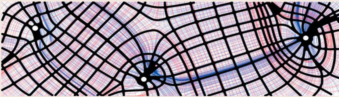
Fig. 3 Slab principal movement trajectories and derived rib geometry Obr. 3 Deskové hlavní momenty a odvozená geometrie žebírek
