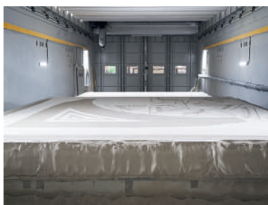
Fig. 6 Sandbett-3D-Druckanlage. 3D sand printer.
