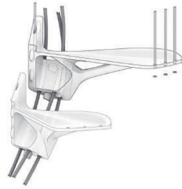
Fig. 15 Elemente der Treppe mit Formgedächtnis-Stäben, Trittstufen und Absturz-sicherung. Elements of the stairs with memory alloy bars, steps and railing. (© A. Jipa, Digital Building Technologies, ETH Zürich)
