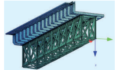
Fig. 3 FE-Modell für die Brücke. FE model of the bridge.
